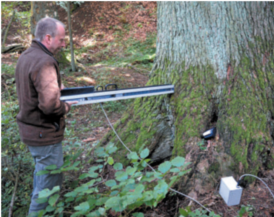
Schonende Altersermittlung mit dem Resistographen (Fa. Rinntech).
